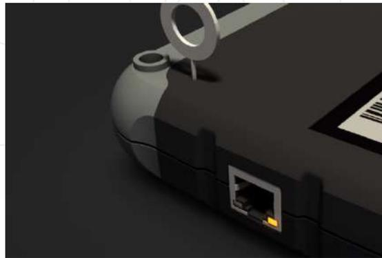
E' inoltre possibile collegare il **FIX REMOTE** anche tramite cavo Ethernet direttamente alla rete dell'officina. In questo modo non è necessario seguire la guida di configurazione appena descritta.
